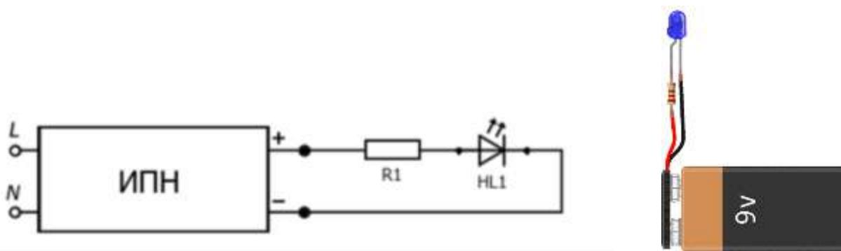
Короткую ножку светодиода (катод) нужно соединять с минусом, длинную (анод) – с плюсом. Если подключили правильно, то светодиод должен загореться.
